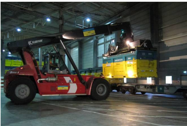
Abb. 13: Bahnverladung mit einem Reachstacker
