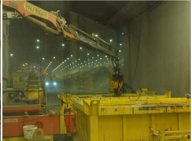
Abb. 10: Probenahme mit Probenarm
