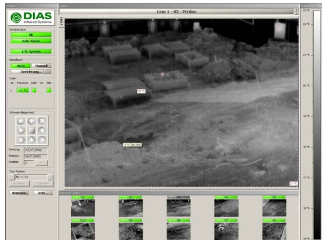
Abb. 3: Überwachung mittels Wärmebildkamera
